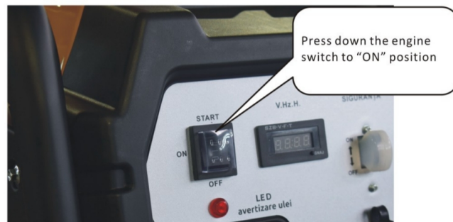
2.2. Setati comutatorul motorului in pozitia ON.
